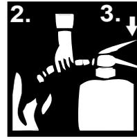
2. Löschschlauch fassen, Löschdüse auf Brandherd richten.
