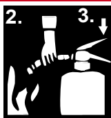
2. Schlauch fassen und Düse aus einem Abstand von 2 - 2,5 m auf den Brandherd richten
